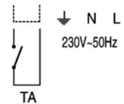
**Quando si collega il termostato ambiente è necessario eliminare il ponte premontato (TA-TA).**
